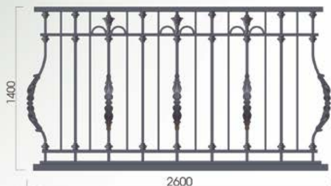
Б.02 Материал: чугунные элементы, стальной прокат
